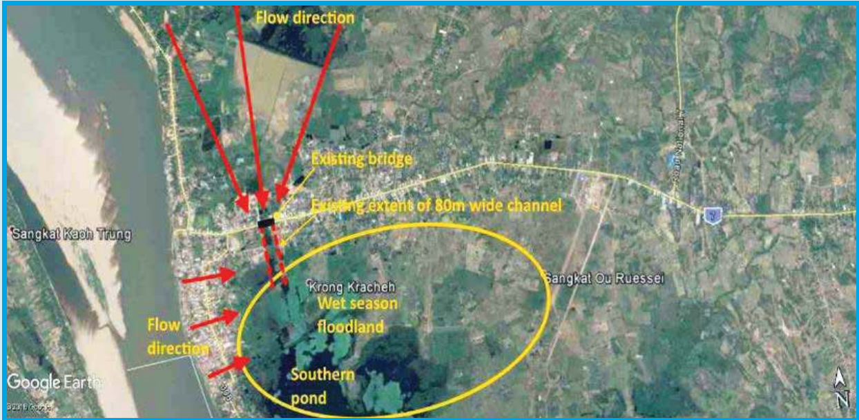
រូបភាពទី ៥១៖ លំហូរទឹកក្នុងប្រព័ន្ធបង្ហូរទឹកបច្ចុប្បន្នសម្រាប់ក្រុងក្រចេះ (ប្រភព៖ ការងារផ្ទាល់ខ្លួន ដោយផ្អែកលើ ADB, ២០១៨)
